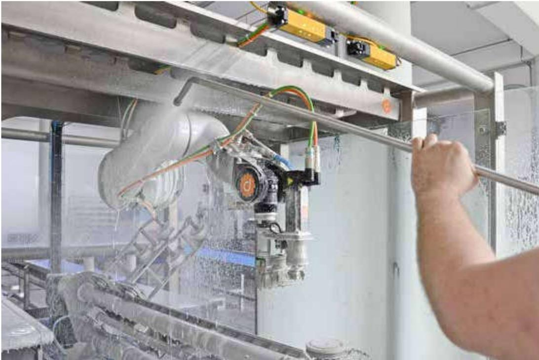
Der Roboter wird von innen mit bis zu 50 mbar Druck beaufschlagt, sodass von außen kein Reinigungsmittel eindringen kann. **Er verträgt das Abstrahlen mit heißem Wasser, das Einschäumen mit Reinigungschemikalien und manuelles Bürsten.**
