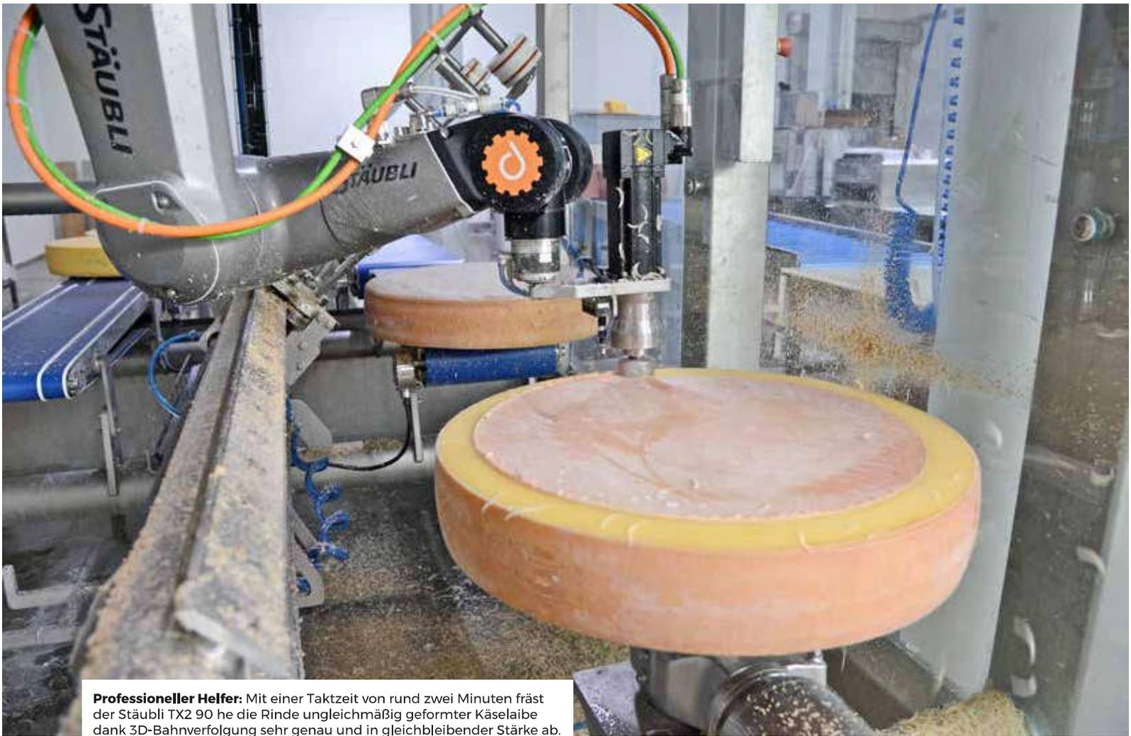
**Professioneller Helfer:** Mit einer Taktzeit von rund zwei Minuten fräst der Staubli TX2 90 he die Rinde ungleichmäßig geformter Käselaibe dank 3D-Bahnverfolgung sehr genau und in gleichbleibender Stärke ab.
