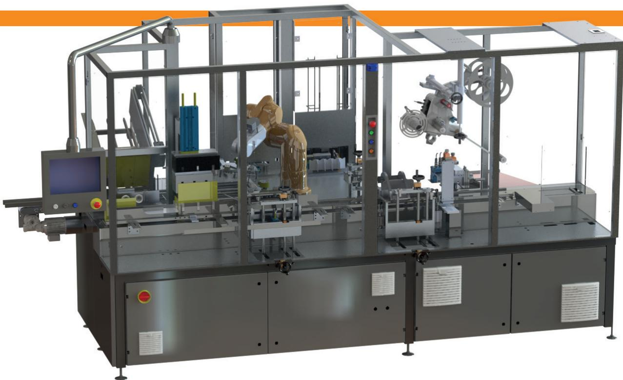
Der 6-Achs-Roboter ermöglicht flexible Verpackungslösungen für Vials inklusive Beipackzettel in Faltschachteln mit möglicher Zugabe eines Zwischenfächers.
