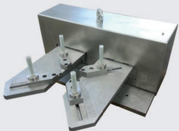
**Spannvorrichtung für Schleifscheiben**
